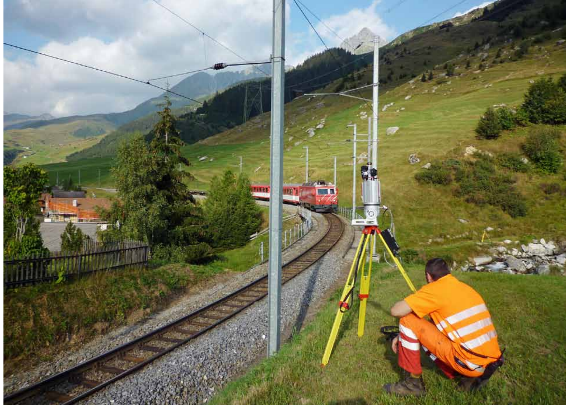
Statische Vermessung im laufenden Betrieb: Das Bahnviadukt im Val Strem wurde von einem Dutzend fixer Punkte aus erfasst.
