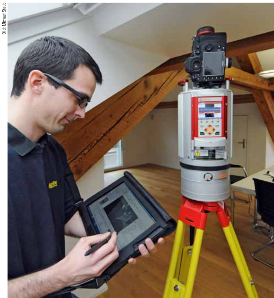
Jürg Pulfer von der Terradata AG demonstriert das Scansystem: Auf dem Laserscanner sitzt eine Digitalkamera mit kalibriertem Objektiv. Beide Geräte übermitteln ihre Daten kabellos auf das Tablet.
