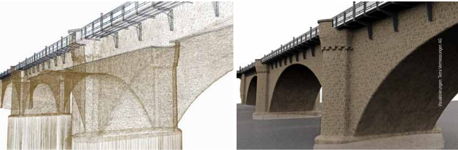
Die Laser-Punktwolke der Rheinbrücke Eglisau ermöglicht verschiedenste Darstellungen: links ein Gitternetz, rechts die 3D-Visualisierung.
