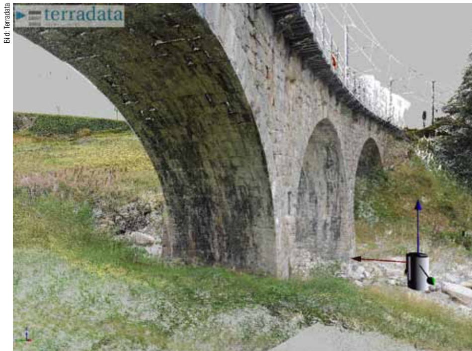
Aus vielen Einzelscans wird eine kolorierte Punktwolke berechnet. In diesem Fall zeigt sie wegen der Live-Erfassung auch einen «Geisterzug» auf dem Viadukt.
