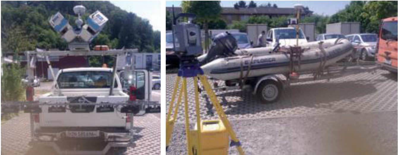
Terra Vermessungen AG nutzt und kombiniert die verfügbaren Mess-, Positionierungs- und Untersuchungsgeräte für ein schnelles Präzisionsscanning von Fahrzeugen aller Art wie Boot, Bahn oder Auto.
