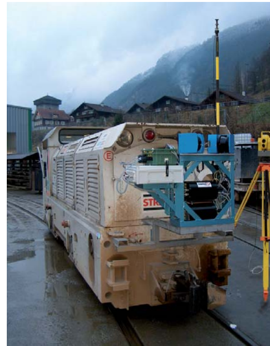
Abb. 1: Scan-Ausrüstung auf Stollenlok montiert.
